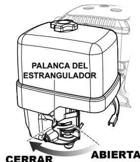
Figura 14. Palanca del estrangulador (Cerrada)
