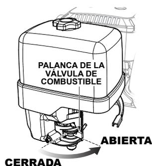
Figura 12. Palanca de la válvula de combustible del motor (posición ABIERTA)
