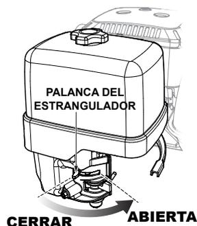
Figura 18. Palanca del estrangulador (abierta)
