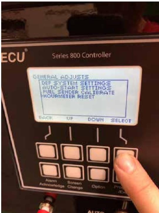
**Figure 20. Hourmeter Reset**
