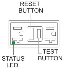
Figure 10. 120-Volt GFCI Receptacle
