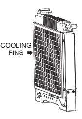
Figure 27. Radiator (Cooling Fins)
