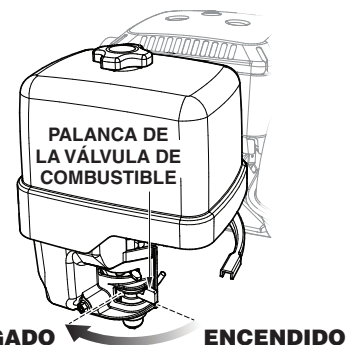
Figura 18. Palanca de la válvula de combustible (apagado)
