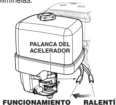
Figura 15. Palanca del acelerador (funcionamiento)
