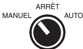
**Figure 17. Interrupteur ON et OFF manuel (Position Man.)**
