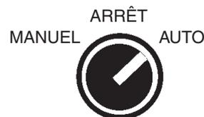
**Figure 19. Interrupteur ON et OFF manuel (Position AUTO)**
