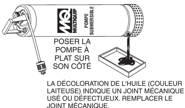
Figure 22. Inspection de l'huile de lubrification
