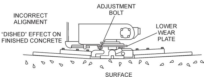
**Figure 28. Worn Arm Bushings**
