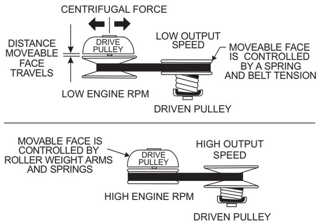
Fig. 23. Pulley Interaction
