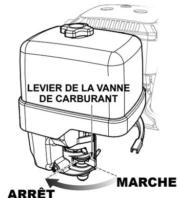
Figure 15. Levier du robinet de carburant (ARRÊT)
